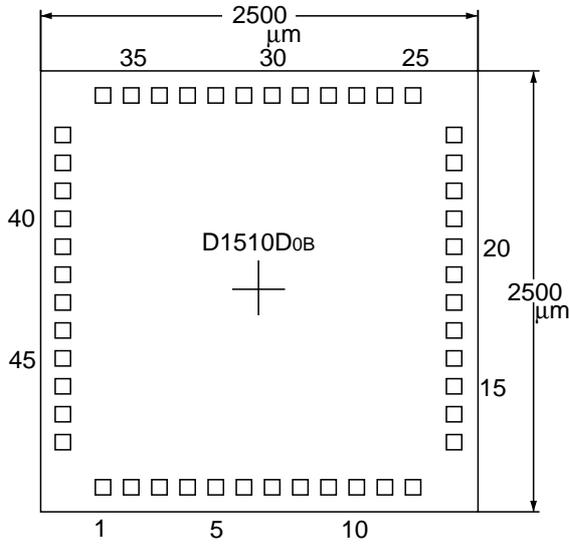
Chip size: 2500µm × 2500µm
